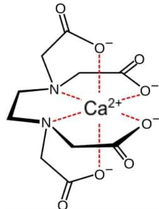
La reacción entre el EDTA y el  $\text{Ca}^{2+}$  se da en estequiometría 1:1, significando esto que cada mol de calcio reacciona con un mol de EDTA respectivamente.
