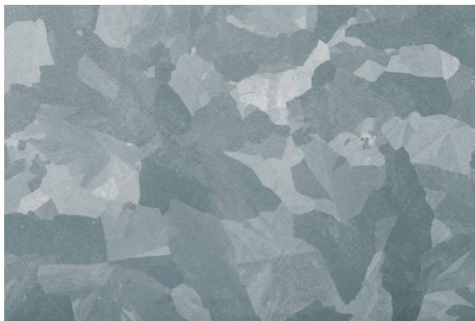
Cristales de zinc característicos de las láminas galvanizadas
