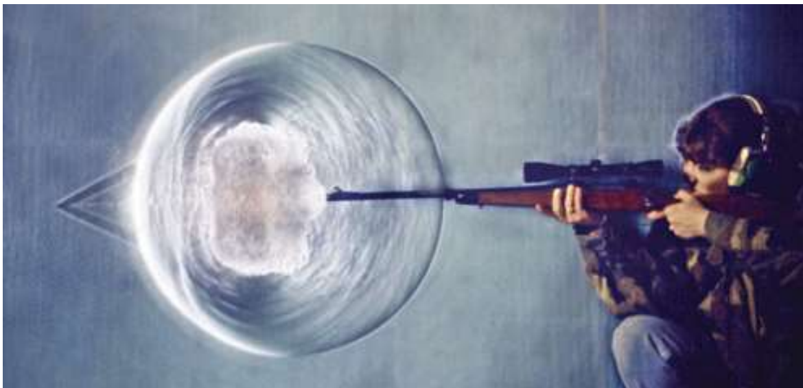
Figura 1. Onda de choque generada por la deflagración de la pólvora (concéntrica) y del proyectil moviéndose a velocidad supersónica (cónica).
